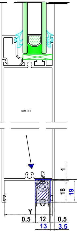
ПРИМЕР УСТАНОВКИ ПОРОГА АРТ.470 MINI НА АЛЮМИНИЕВУЮ ДВЕРЬ 1-ый вариант
