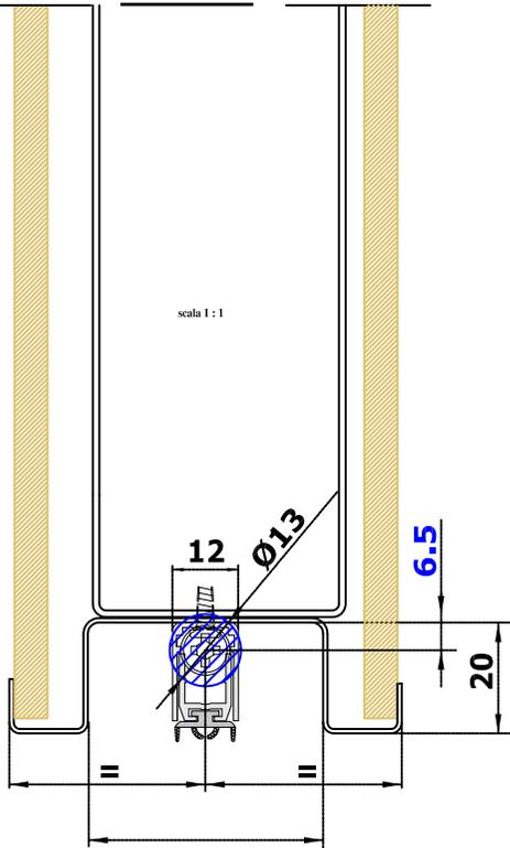
ПРИМЕР УСТАНОВКИ ПОРОГА АРТ.470 MINI НА БРОНИРОВАННУЮ ДВЕРЬ 2-ой вариант
