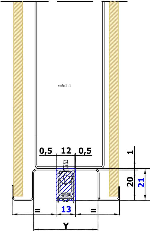
ПРИМЕР УСТАНОВКИ ПОРОГА АРТ.470 MINI НА БРОНИРОВАННУЮ ДВЕРЬ 1-ый вариант
